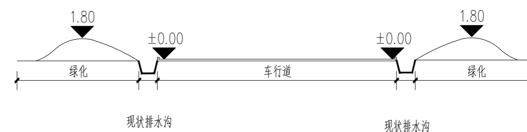
土方整理标准段立面示意图一 1:300
