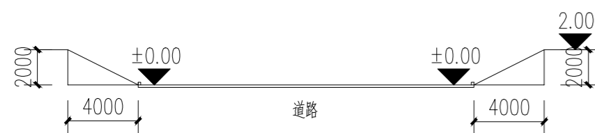
土方整理标准段立面示意图三 1:300
